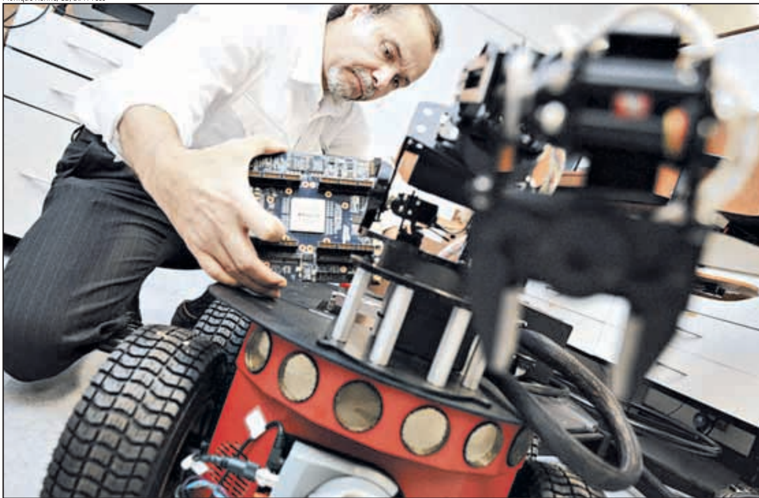
Llanos, da Universidade de Brasília, com um robô que usa a placa FPGA, uma das peças responsáveis pelos novos padrões de processamento de dados
